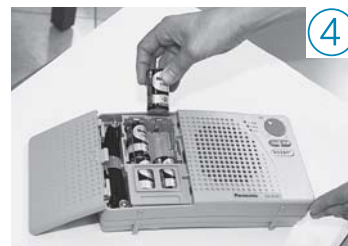
4. 乾電池をはずす ※新しい電池と古い電池を混ぜたり、違う種類(アルカリ・マンガン等)の電池を混ぜたりして使うと、乾電池の破裂や液漏れのおそれがあります。
