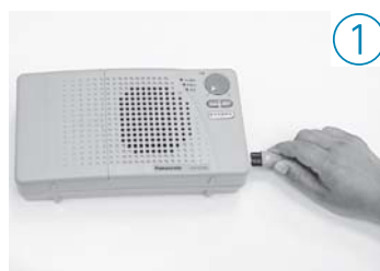
1. 電源スイッチを「切」にし、電源コードをはずす
