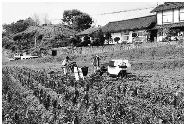
刈取り機(左)と脱粒機(右)による収穫作業
